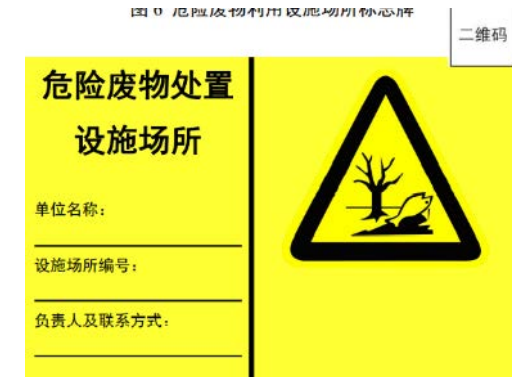
图7 危险废物处置设施场所标志牌
